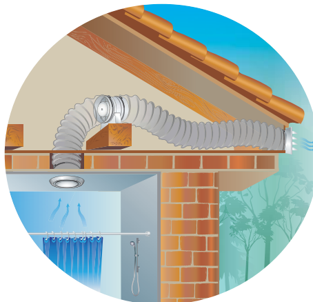
VKOk fan cottage ventilation example
